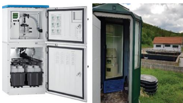
Slika 4. Automatski uzorkivač (lijevo) i uzorkivač postavljen na deponiji Smiljevići
