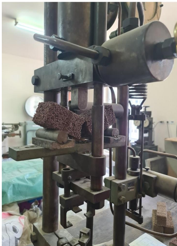
Slika 9. Fotografija pri ispitivanju čvrstoće pri zatezanju savijanjem
