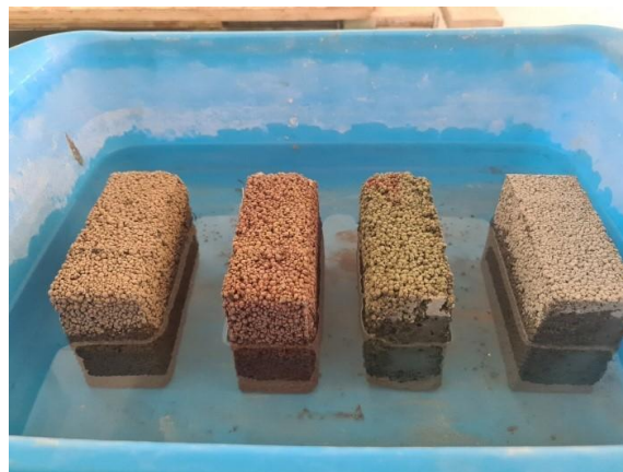
Slika 6. Fotografija faze zasićenja uzoraka postepenim potapanjem prilikom merenja upijanja vode
