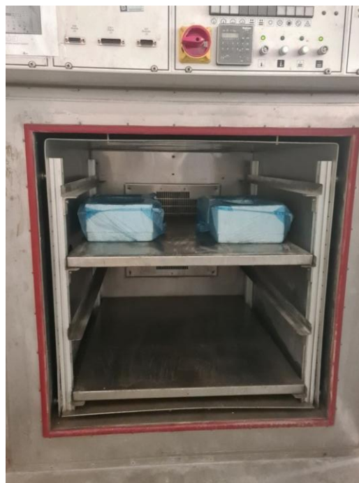
Slika 11. Fotografija pri ispitivanju na istovremeno dejstvo mraza i soli
