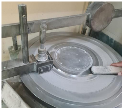
Slika 12. Fotografija pri ispitivanju otpornosti na habanje brušenjem
