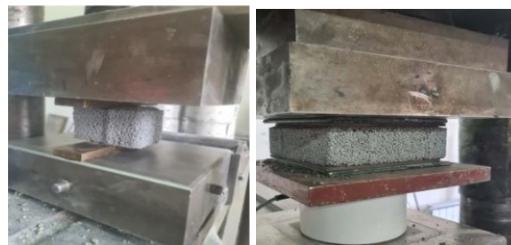
Slika 7. Fotografije ispitivanja čvrstoće pri pritisku (levo) i nosivosti (desno)
