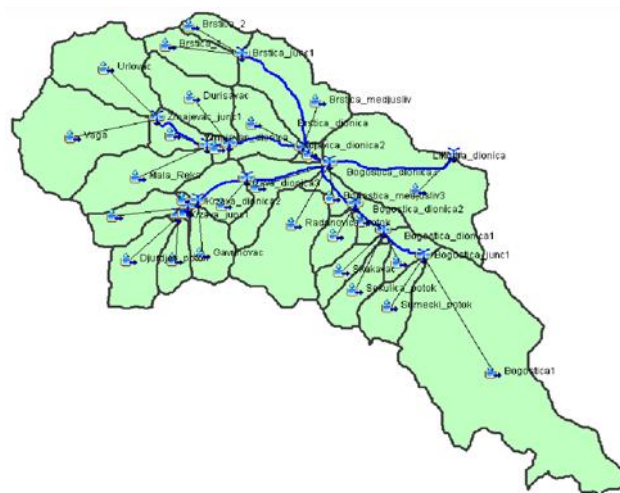
Slika 6. Računska struktura sliva uzvodno od Krupnja u programu HEC-HMS
