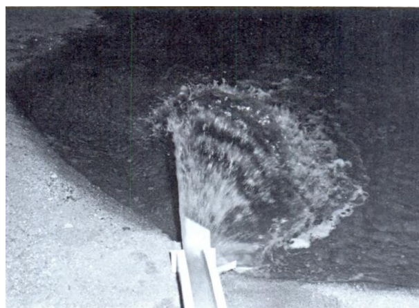
Slika 2. Domet i širenje mlaza ski odskoka na modelskom ispitivanju (Beichley, 1971)
