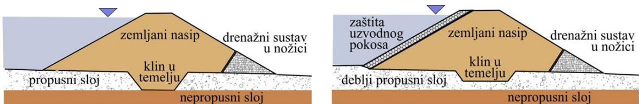
Slika 5. Primjeri homogenih nasipa na propusnom temeljnom tlu
