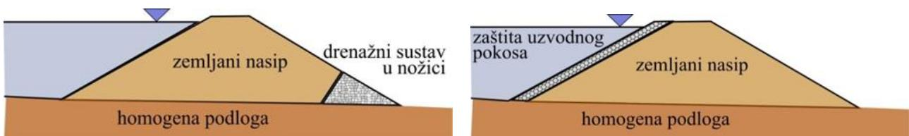
Slika 4. Primjeri homogenih nasipa na homogenom, slabo propusnom, temeljnem tlu
