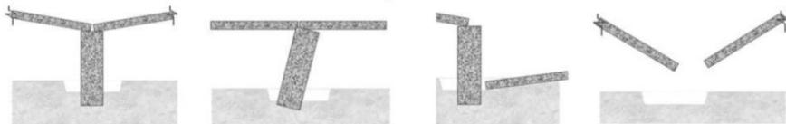
Slika 4. Vrste mostovskih oštećenja usled lokalne erozije rečnog korita; sleva udesno: sleganje stuba; rotacija stuba; erozija tla u zaleđu mostovskog oporca i njegova deformacija, koja može dovesti do rušenja kolovozne konstrukcije; kolaps kolovozne konstrukcije zbog prelivanja ili gubitka oslonca - rušenja stuba (prema [1]).
