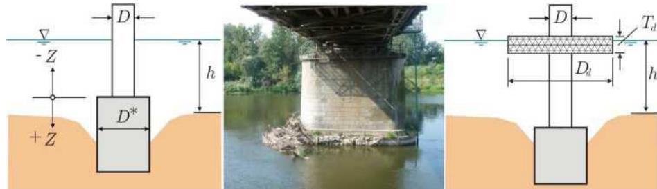
Slika 10. Ekvivalentni prečnik stuba i snimak naplava oko stuba mosta na V. Moravi kod Markovca.
