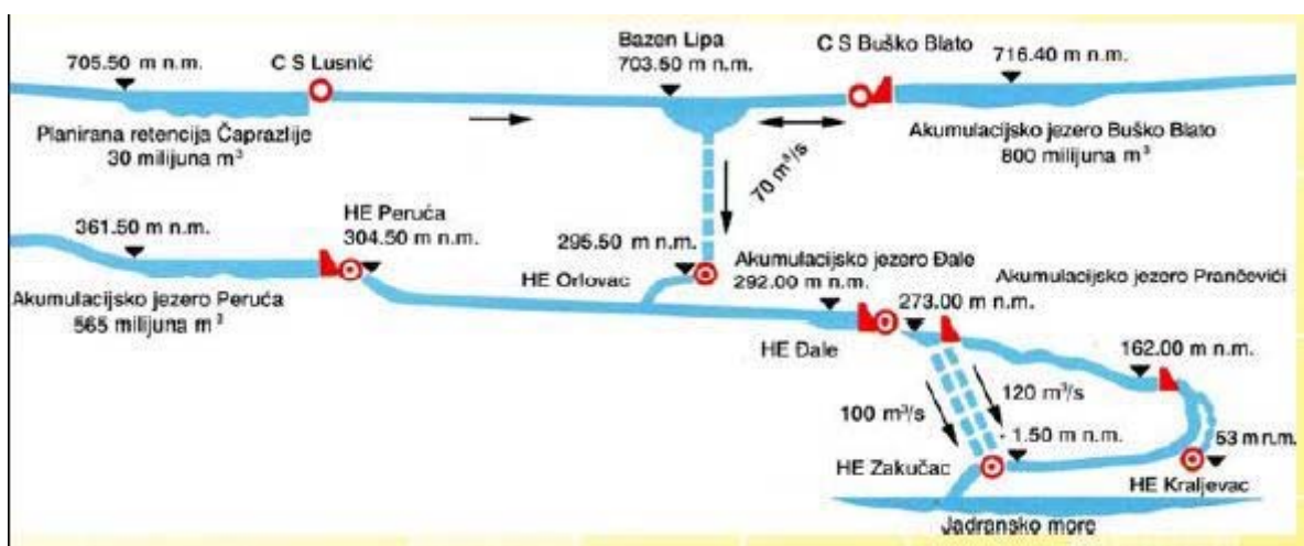
Slika 13. Shema s visinskim kotama sustava Buško Blato-Cetina [7]
