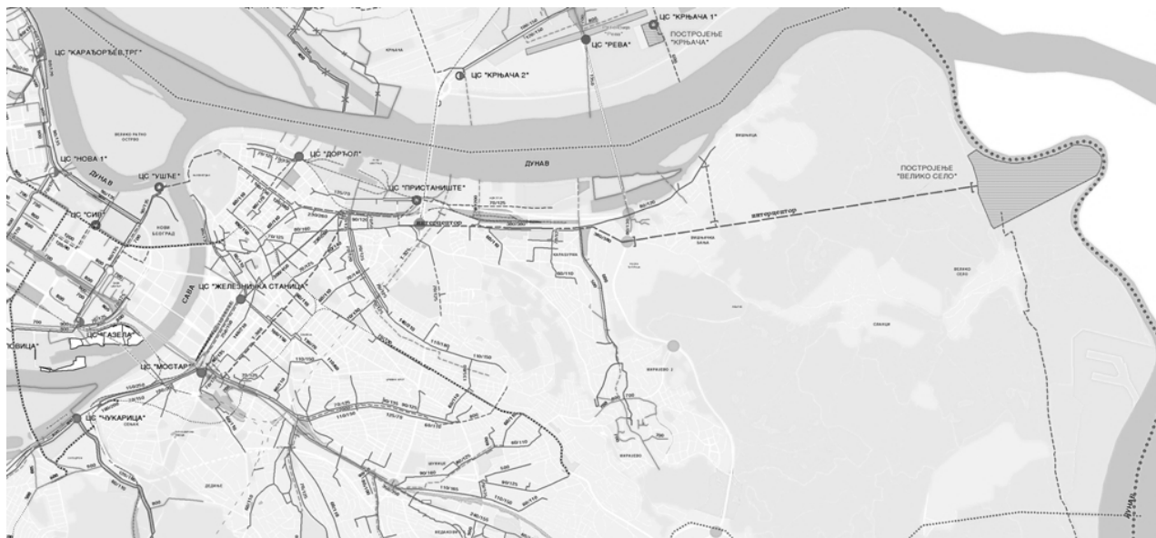
Slika 1. Trasa Interceptora Ušće – Veliko Selo i položaj budućeg postrojenja za prečišćavanje otpadnih voda u Velikom Selu (Generalni plan kanalisanja Beograda)
