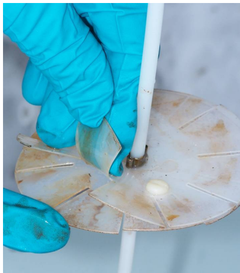
Slika 5. Inhibitor vertikalnog kretanja vode u bušotini namontiran na tubu okidača Snap Samplera (Britt 2005)
