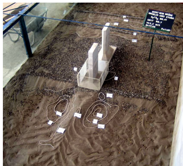
Slika 1. Hidraulički modeli za ispitivanje lokalne erozije dunavskog korita oko mostovskih stubova i varijantnih rešenja zaštite stubova; levo: model iz 1974. godine, stub S41 (pogled nizvodno); desno: model iz 2008. godine, stubovi S41 i S41' (pogled uzvodno). Oba modela su izradjena u nedistordovanoj razmeri 1:40. Slika desno prikazuje deformaciju korita u toku izgradnje stuba S41', sa osiguranjem korita oko zagata tepihom od krupnog kamena [2,4,5].
