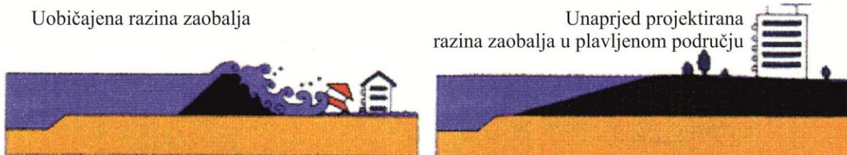
Slika 28. Zaštita građevina od prelijevanja nasipa [9]
