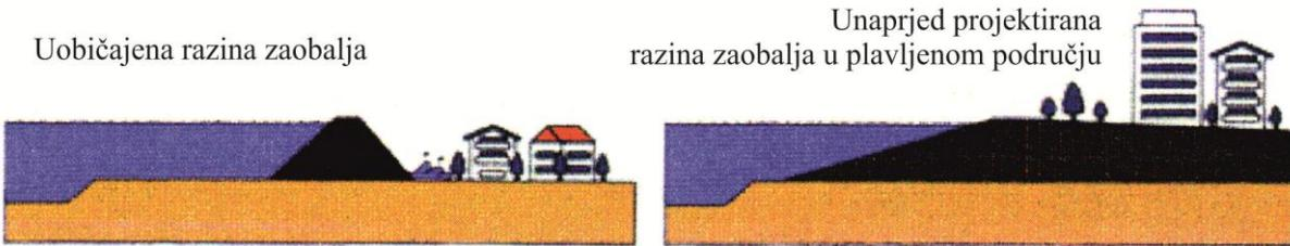
Slika 29. Zaštita od procjeđivanja kroz nasip i visokih podzemnih (zaobalnih) voda [9]
