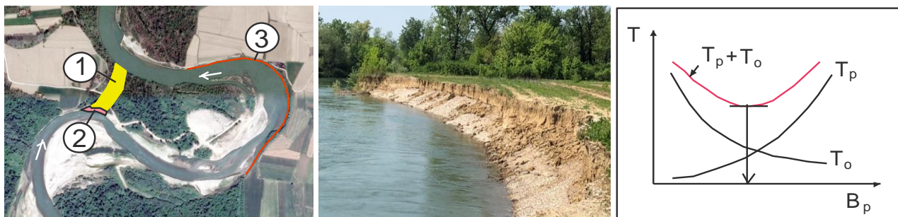
Slika 2. Prosek u funkciji rasteretnog kanala; 1-prosek; 2-prelivni pregradni objekat sa krunom na nivou male ili srednje vode; 3-obaloutvrda; optimalna širina proseka B_p je rezultat sumiranja troškova izgradnje proseka i pregradnog objekta T_p i troškova zaštite obale starog korita od erozije T_o ; povećanjem širine B_p rastu troškovi T_p , a smanjuju se troškovi T_o , jer se zbog smanjenja protoka i brzine toka u starom koritu za obaloutvrdu mogu primeniti lakša konstruktivna rešenja.
