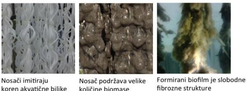
Slika 5. Način formiranja i karakteristike fiksnog biofilma metaboličkog mrežnog reaktora na sintetičkom korenu [6]
