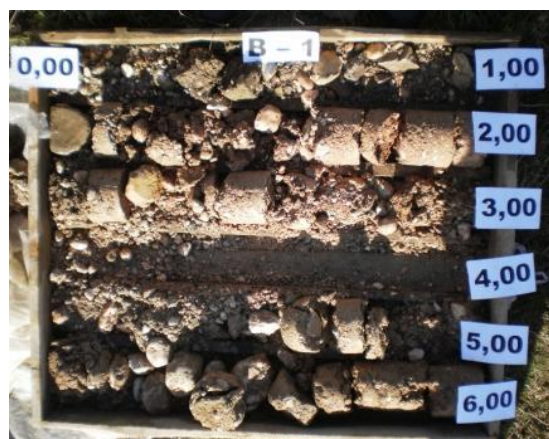
Slika 11. Uzorak materijala tla iz iskopane bušotne (kota trena 510,52 m n.m.) - dio bušotine
