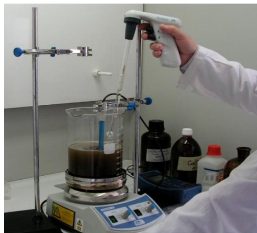
Slika 2. Podešavanje pH vrijednosti do 8,5 [10]
