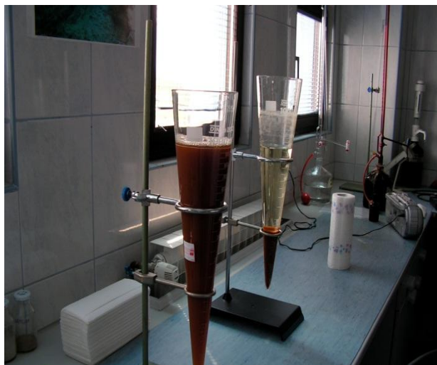
Slika 3. Taloženje uzorka u Imhoffovom lijevku (lijevo uzorak na samom početku taloženja a desno, uzorak u Imhoffovom lijevku nakon 17h).[10]
