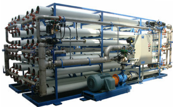
Slika 5. Primer postrojenja reverzne osmoze u fabrici za prečišćavanje vode
