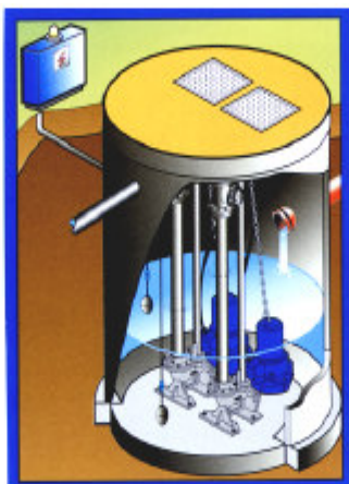
Slika 8. Instalacija sabirnog šahta sa kanalizacionom pumpom opremljenom seckalicom
