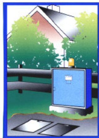
Slika 8. Instalacija sabirnog šahta sa kanalizacionom pumpom opremljenom seckalicom
