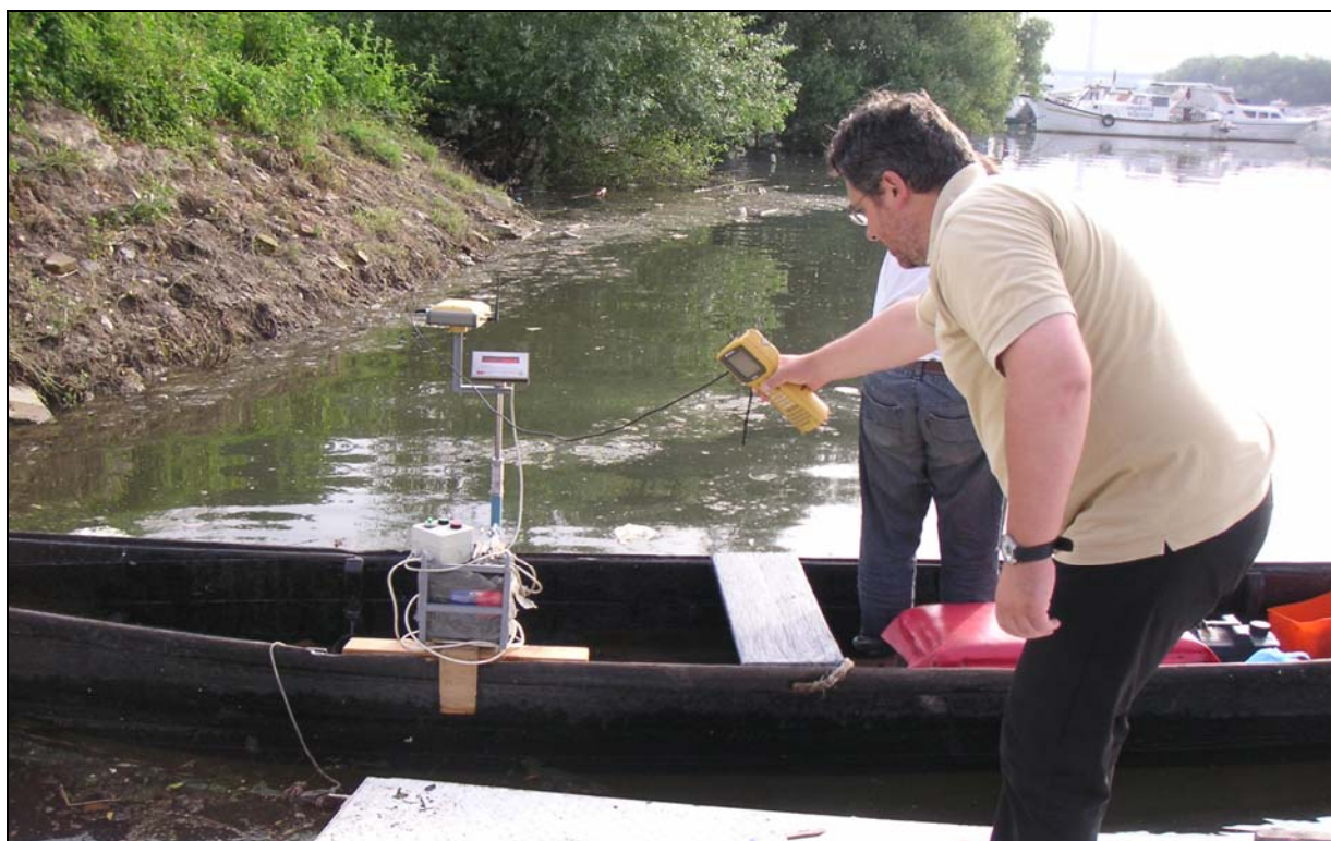
Slika 4: GPS antena (žuta kutija) i dvikomponentna EM sonda (vidi se samo gornji deo, sa elektronikom i displejom) montirani na ribarski čamac
