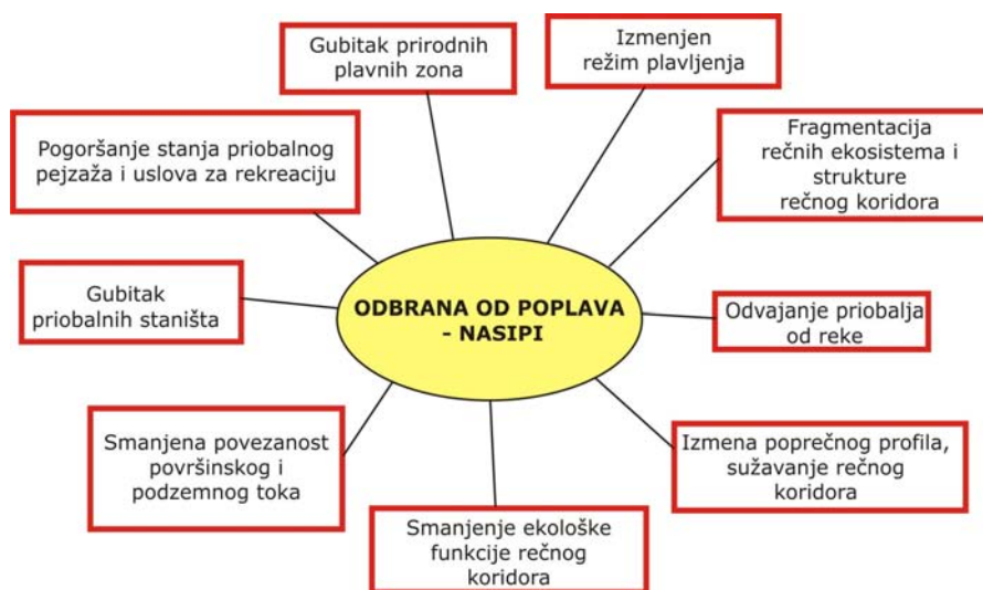
Slika 5: Promene na vodnim telima izazvane izgradnjom nasipa
