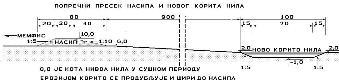
Слика 10. Поглед низводно, попречни пресек кроз насип и ново корито реке Нил. Вертикалне димензије су увећане два пута. Нил ће временом повећати дубину тока и прошириће се до насипа.
