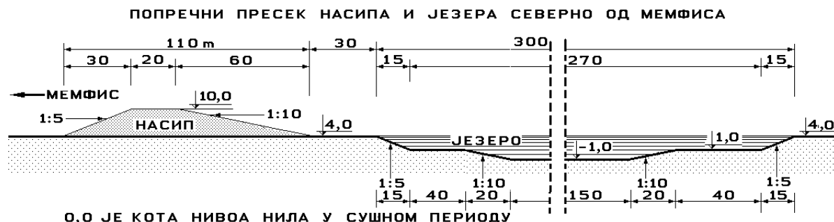
Слика 9. Попречни пресек кроз насип и језеро северно од Мемфиса. Вертикалне димензије су увећане два пута.
