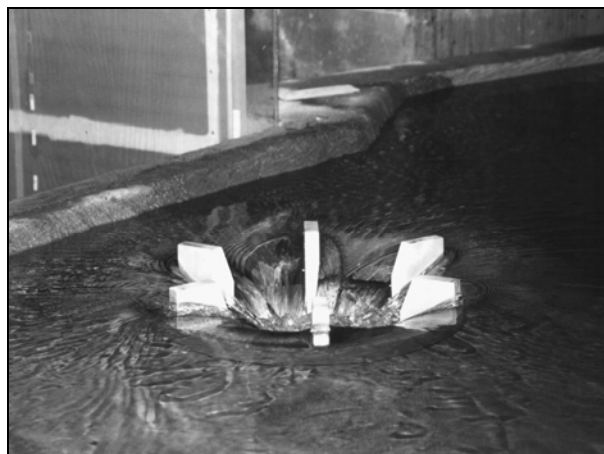
Slika 8. Izgled šahtnog preliva sa vodenom pečurkom za maksimalni proticaj u slučaju korigovanog uzvodnog dela zaseka
