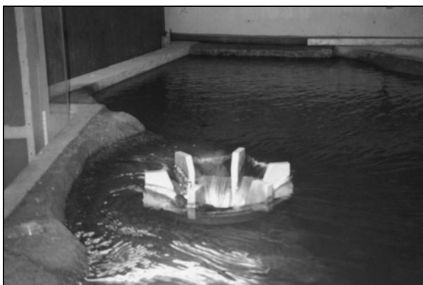
Slika 7. Izgled šahtnog preliva sa projektovanim zasekom
